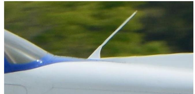
アンテナ(金属製機の例)
